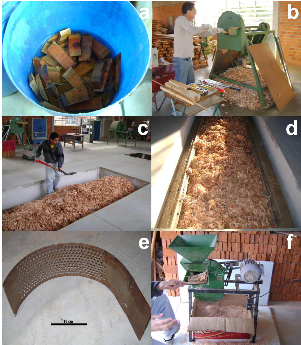
Figura 5. Processo de obtenção das partículas de madeira utilizada na manufatura dos painéis. Imersão dos blocos de madeira em água (a); obtenção das lascas no flaker (b); revolvimento e secagem das lascas (c e d); peneira utilizada para obtenção das partículas (e); e transformação das lascas em partículas no moinho de martelos (f).
