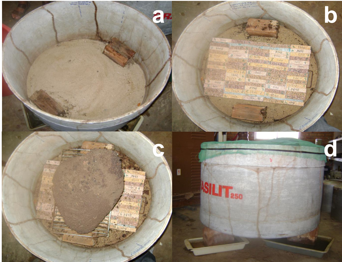
Figura 14. Caixa de fibra-cimento com capacidade 250L com a camada de 10 cm de areia (a), disposição das amostras em blocos ao acaso (b), instalação da colônia sob as amostras (c) e visualização externa da caixa fibra-cimento com meios utilizados para evitar a fuga dos térmitas (d).
