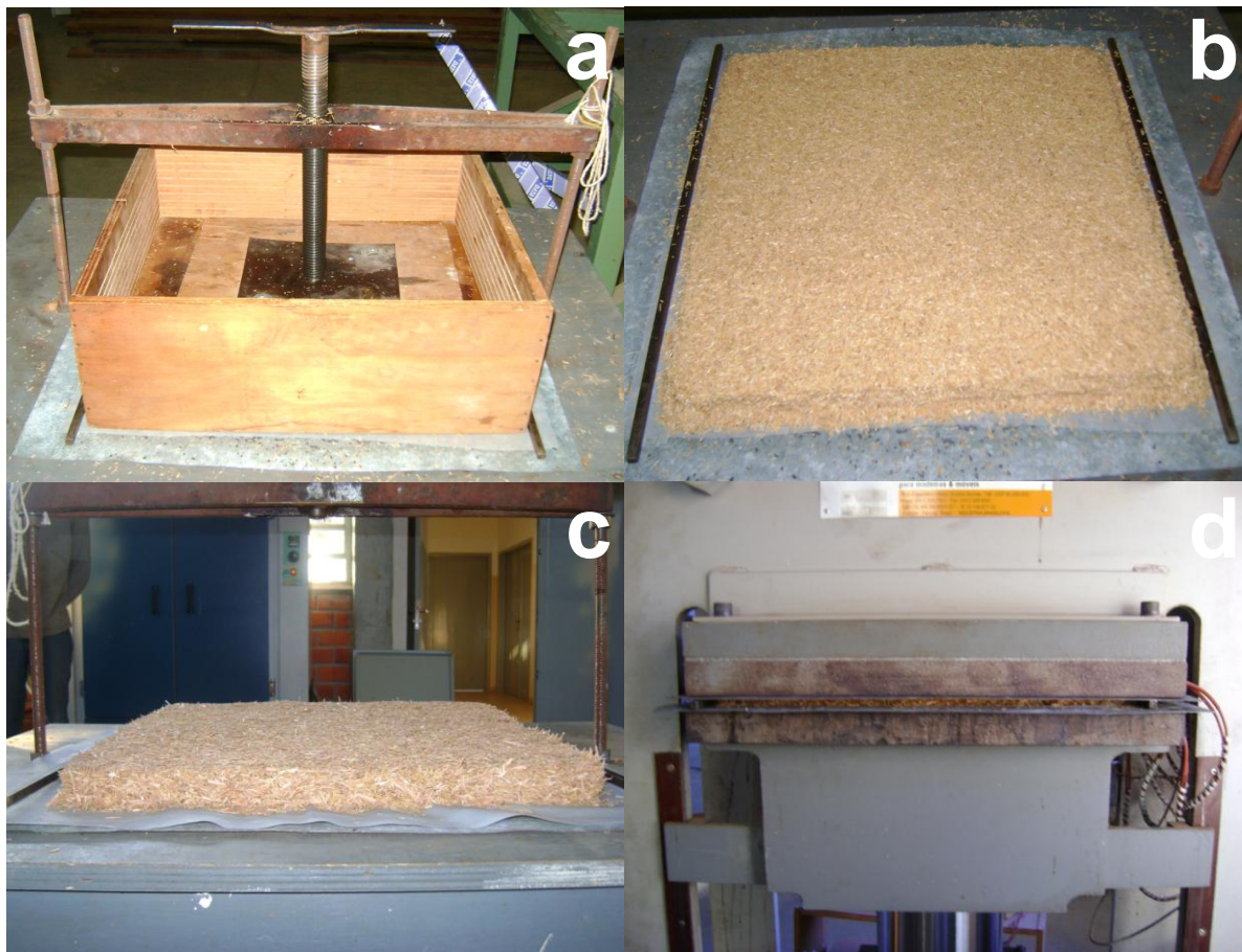
Figura 8. Prensagem do colchão a frio em caixa formadora (a), visualização frontal (b) e lateral (c) do colchão após prensagem manual, e prensagem definitiva a quente em prensa hidráulica (d).
