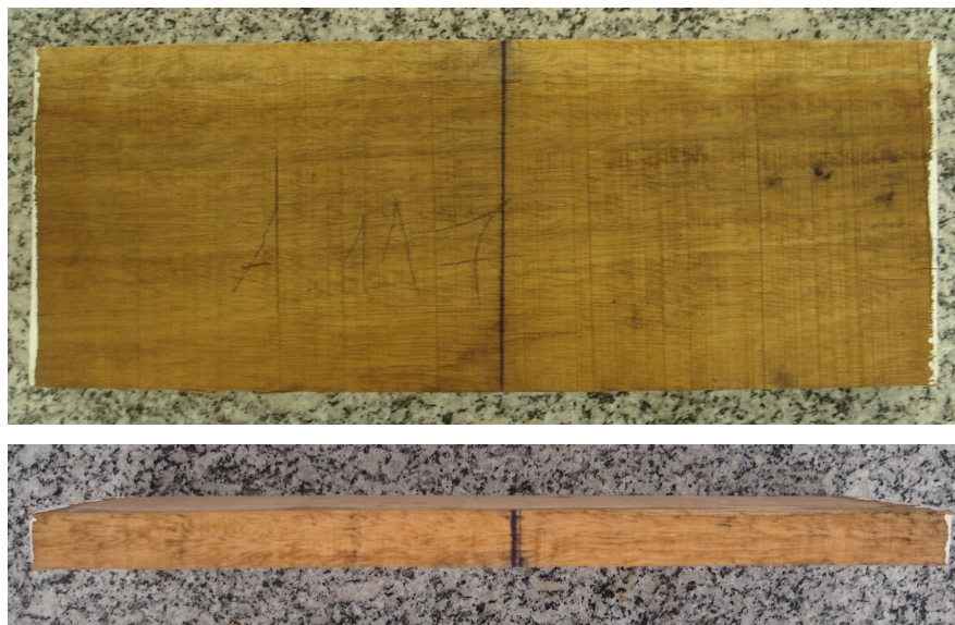
Figura 9 – Demarcação dos pontos de medição das contrações tangenciais e radiais.
