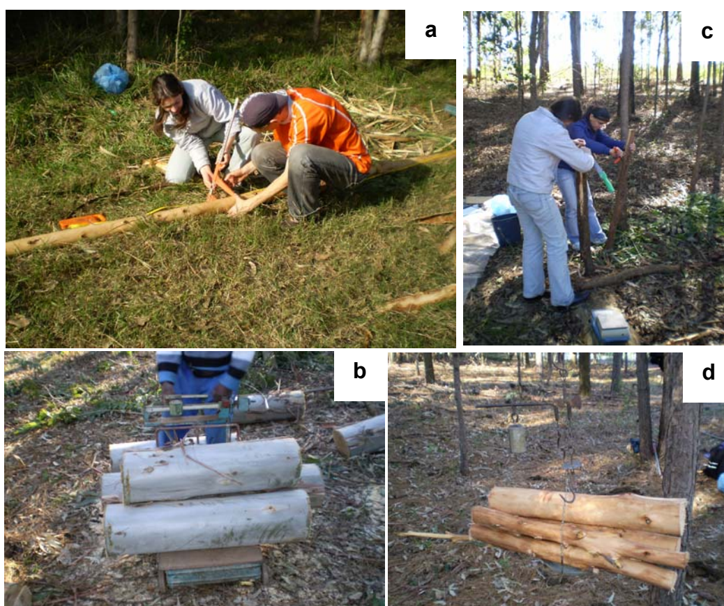
Figura 9 - Cubagem pelo método de Smalian (a); Pesagem dos toretes com casca (b); Descasque (c); Pesagem dos toretes sem casca (d) das árvores-amostra dos povoamentos de E. sp. com 20 (E1), 44 (E2) e 240 (E3) meses de idade, Fepagro Florestas, Santa Maria, RS, Brasil.
