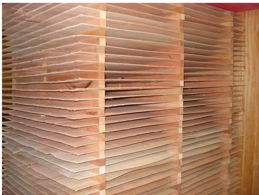
**Figura 1. Pilha de lâminas de eucalipto no interior da câmara climatizada.**
