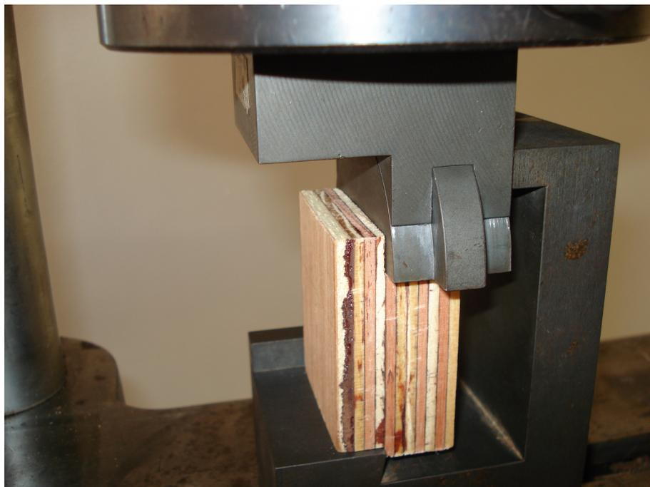
**Figura 13. Corpo-de-prova em cisalhamento na linha de cola a seco, por ensaio de compressão.**
