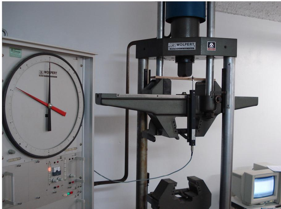
Figura 7. Máquina Universal de Ensaios preparada para ensaio de flexão estática.
