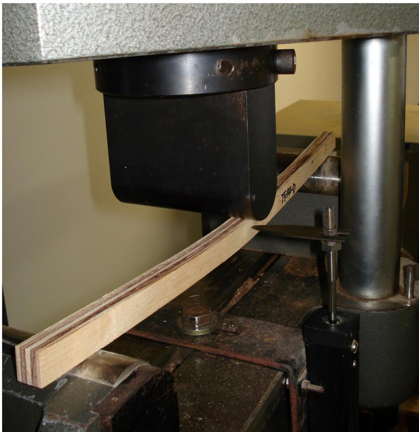
Figura 11. Corpo-de-prova em flexão estática na posição *edgewise*.
