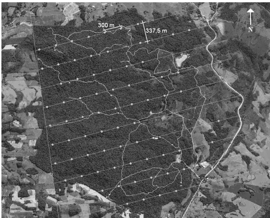
FIGURA 3 – Linhas sistemáticas e pontos amostrais (71) georreferenciados na carta-imagem da Fazenda Tupi, Nova Prata, RS, 2009.
