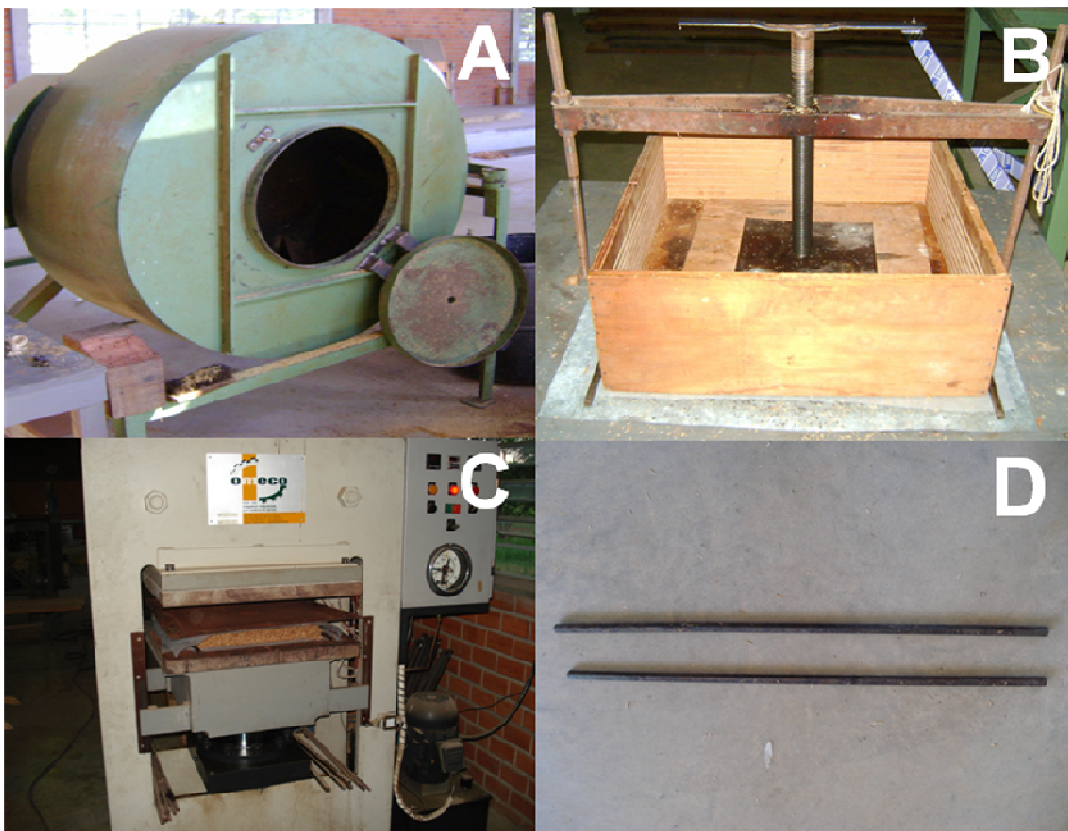
Figura 3 – Processo de produção das chapas aglomeradas. Tambor rotativo (A), prensagem do colchão a frio em caixa formadora (B), prensagem definitiva a quente em prensa hidráulica (C), barras de aço com altura de 9,5 mm (D)
