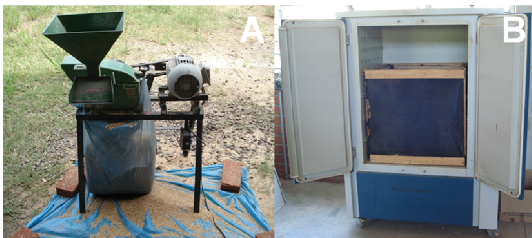
Figura 1 – Processo de preparo das partículas. Moinho de martelos (A), estufa de secagem (B)
