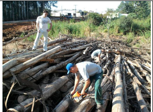
Seccionamento/dimensionamento da madeira com motosserra.
