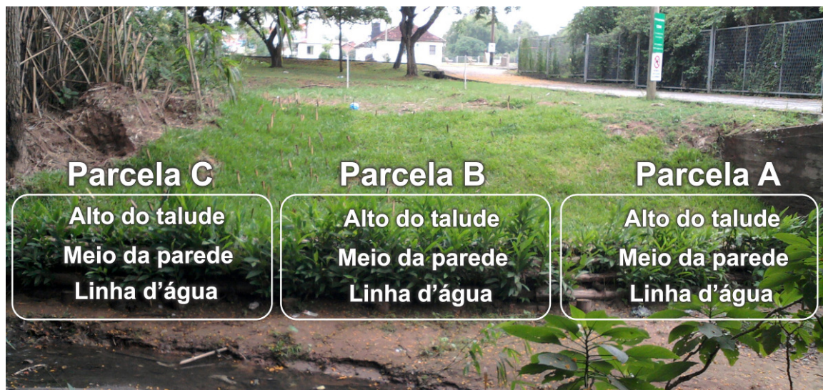
Figura 18 – Esquema do experimento mostrando as parcelas e os tratamentos na parede Krainer.
