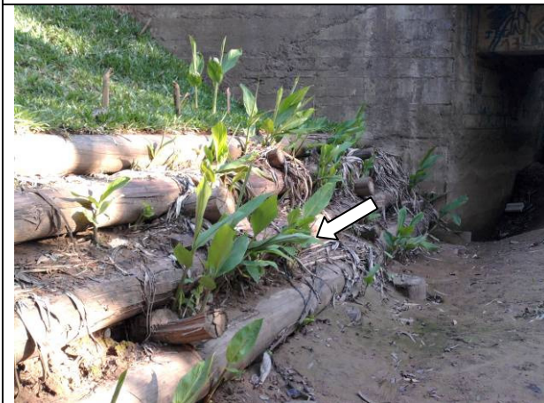
O tratamento Meio da parede obteve a média de 3,42 brotações por metro linear.
