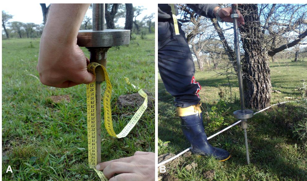
Figura 2 - Medição da profundidade de penetração no solo (A) Medição da penetração no solo; (B) Penetrômetro de Impacto. (Barra do Quaraí, RS, 2012. Fotografias de Cristina Gouvêa Redin).
