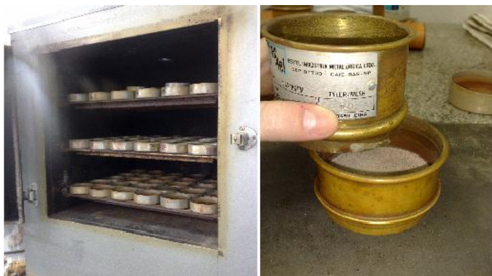
Figura 3 – Análise de textura do solo; Amostras em estufa à 100°C (A); Separação de areia fina e areia grossa com malha especial de 2,50mm (B). (Barra do Quaraí, RS, 2012. Fotografias de Cristina Gouvêa Redin).
