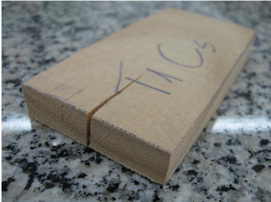
Figura 7: Manifestação de rachadura de topo em Eucalyptus saligna .
