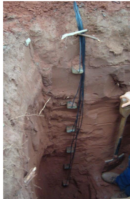
Figura 3 – Conjunto de equipamentos TDR-100 (a); disposição da instalação das sondas nas trincheiras (b).
