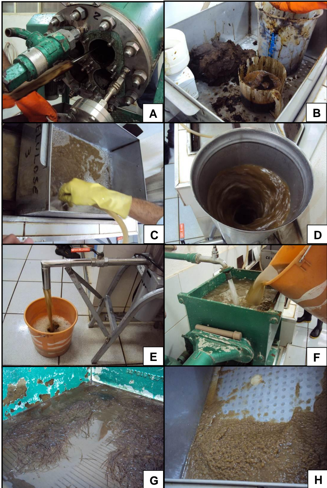
Figura 15 – A) Descarga das fibras dos reatores; B) Coleta de licor negro; C) Lavagem das fibras com água a temperatura ambiente; D) Desfibramento no hidrapulper; E) Descarga das fibras do hidrapulper; F) Depuração das fibras; G) Resíduos sobre o depurador; H) Polpa celulósica após lavagem, desfibramento e depuração. Fonte – Arquivo pessoal.
