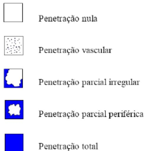
Figura 5 – Critérios usados para classificação da distribuição penetração do produto preservativo na madeira
