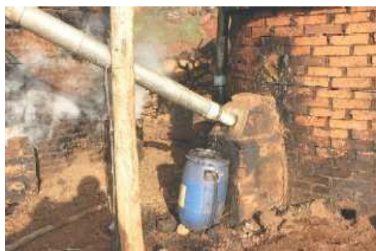
Foto 8. Tecnologia adotada na queima do carvão para diminuição da poluição do ar e reaproveitamento de material para controle natural de pragas.
