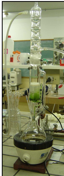
Figura 6 - Extração em aparelho de soxhlet.
