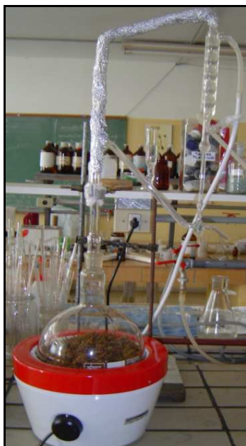
Figura 5 – Hidrodestilação em aparelho de Clevenger.
