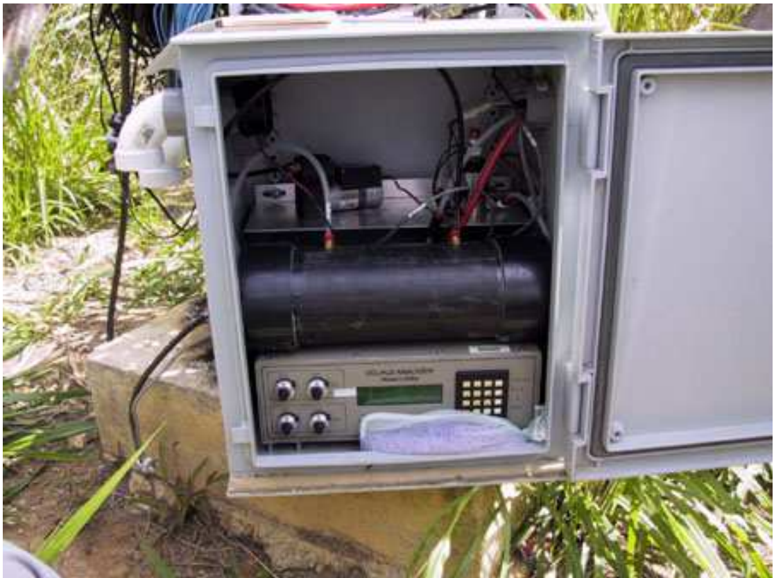
Figura 8: Medidor de concentração de \text{CO}_2 e \text{H}_2\text{O} , IRGA, Licor 6262.
