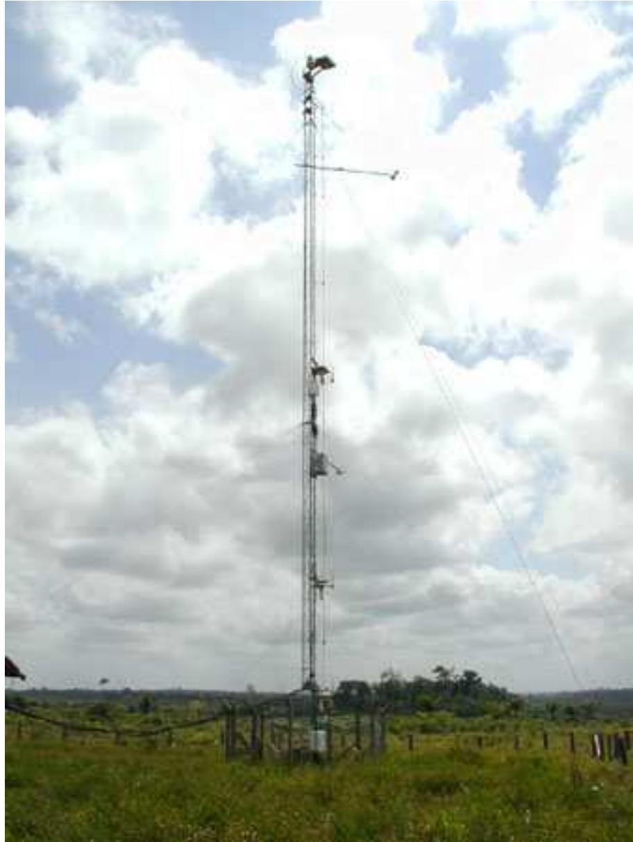
Figura 6: Torre de 28m, com sistema de CT, análise de gás Traço e perfil, Km77 - Santarém/PA.
