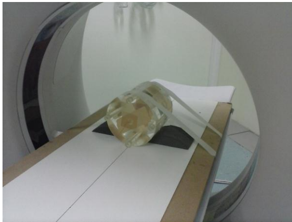
Figura 4: Simulador de crânio posicionado no equipamento de tomografia.
