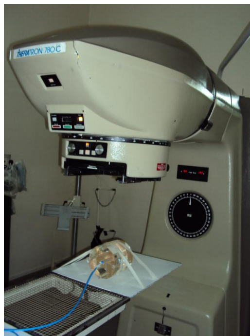
Figura 2: Simulador de crânio posicionado no equipamento Co-60.
