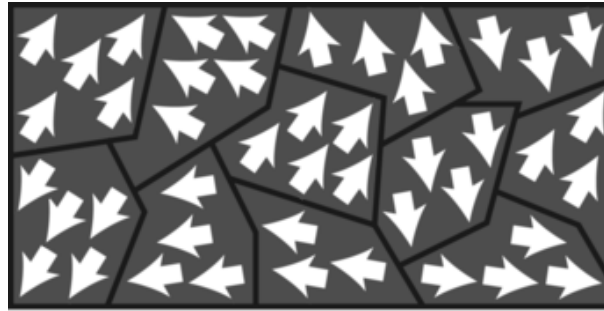
Figura 2.8 – Representação ilustrativa do estado de domínios magnéticos de um material FM desmagnetizado [15].
