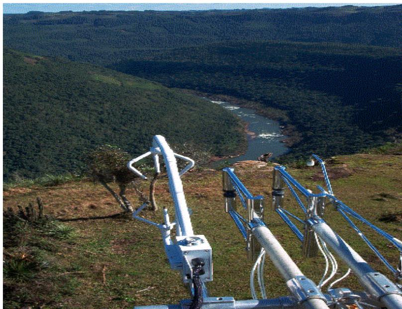
**FIGURA 5.3:** Foto do Anemômetro sônico 3D (CSAT3-CAMPBELL) e higrômetro de Krypton (KH20) ao lado do anemômetro sônico 3D.
