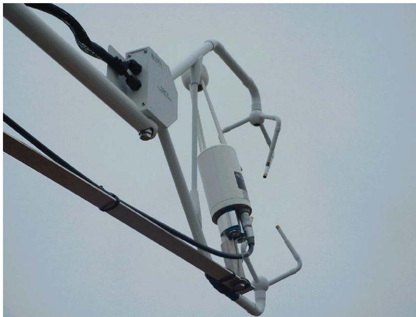
**FIGURA 5.10:** Foto do anemômetro sônico 3D (CAMPBELL) e analisador de gás infravermelho de caminho aberto (Licor 3662 - OPEN PATH)
