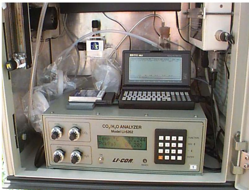
**FIGURA 5.7:** Foto do analisador de gás infravermelho (Licor 6262)
