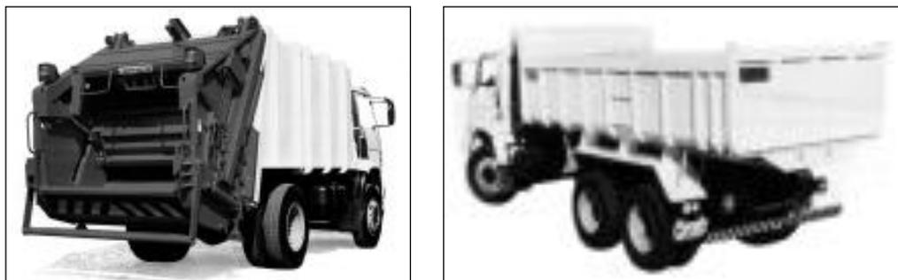
Figura 03- Veículo tipo compactador e sem compactação tipo basculante.
