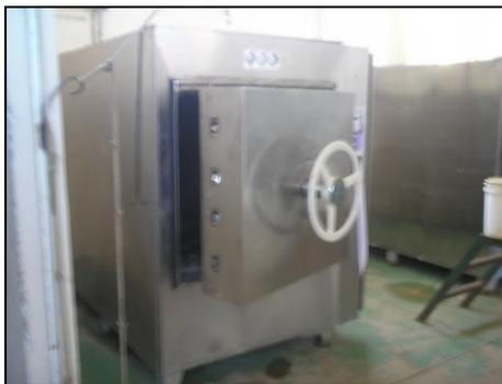
Figura 71- Autoclave utilizada no tratamento dos RSS.
