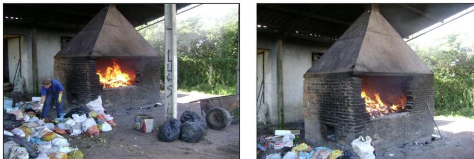
Figura 63- Forno utilizado na incineração dos resíduos/rejeito.
