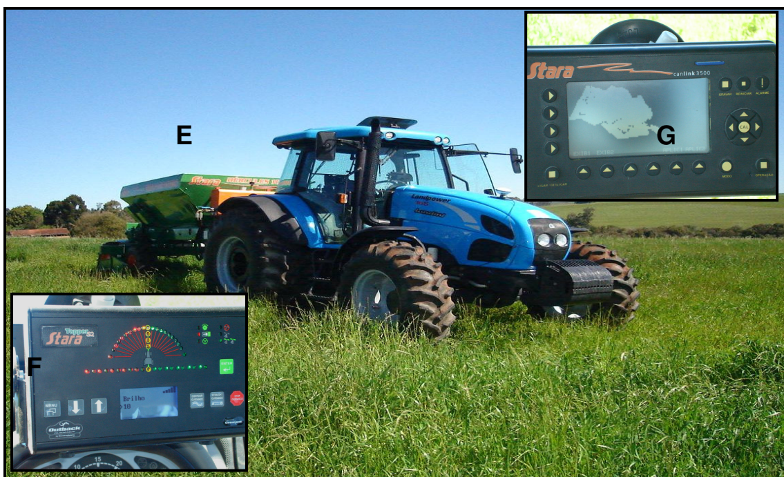
Fotografia 7 – (E) Trator com distribuidor de fertilizantes agrícolas para agricultura de precisão, (F e G) aparelhos acoplados ao trator que direcionam a distribuição dos insumos agrícolas. Fonte: Trabalho de campo, 2008. Org.: CARGNIN, M.
