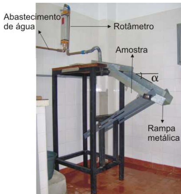
Figura 18 - Equipamento usado para ensaio Inderbitzen (Tatto, 2007)
