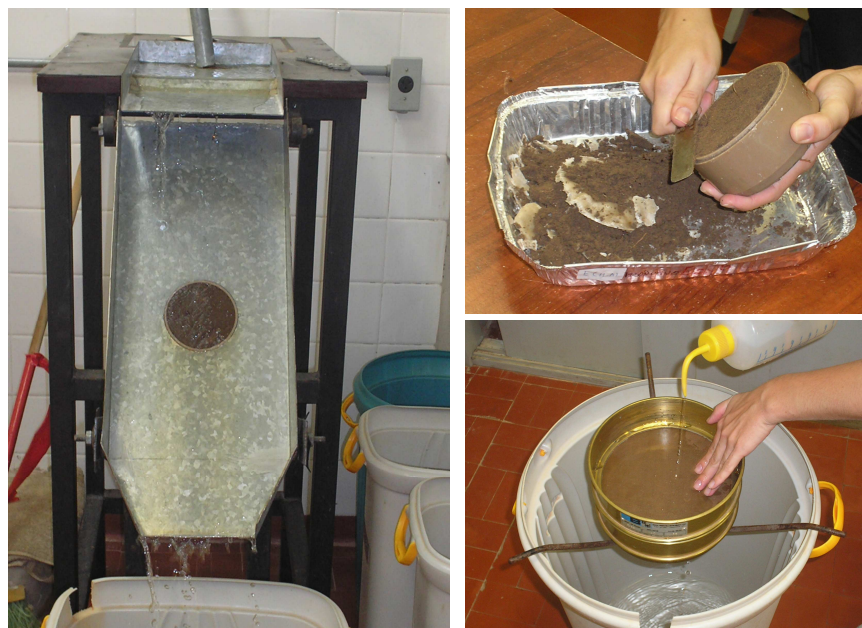
Figura 19 - Etapas da realização do ensaio de Inderbitzen
