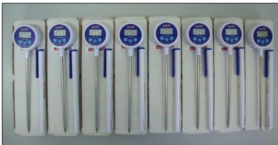
Figura 22. Termômetros digitais modelo Instrutherm TE-400 utilizados na investigação.
