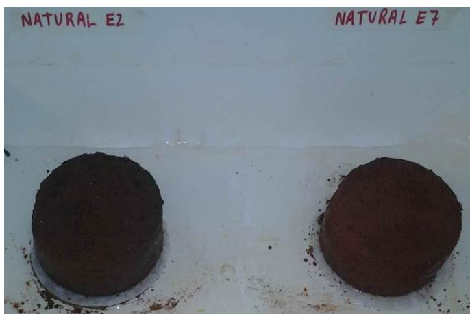
Figura 51: Ensaio de Desagregação Fonte: Lucas D. Rodrigues, Lennon F. Tomassi, Daniel Moraes
