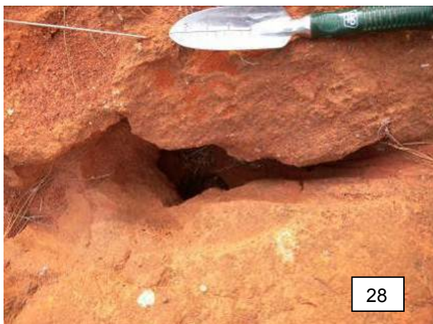
Figura 28 e 29: Formação de placas e dutos subterrâneos
