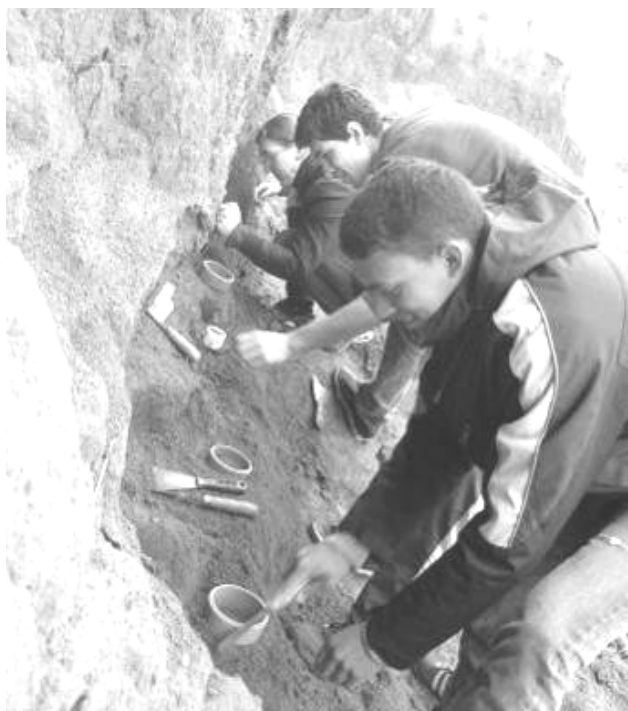
Figura 11: Coleta de amostras indeformadas. Fonte: Arquivos da profª Drª. Andrea V. Nummer
