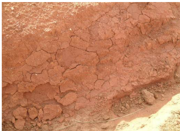
Figura 42: Lâminas de argila, gretas de contração e alguns materiais grosseiros encontrados.
