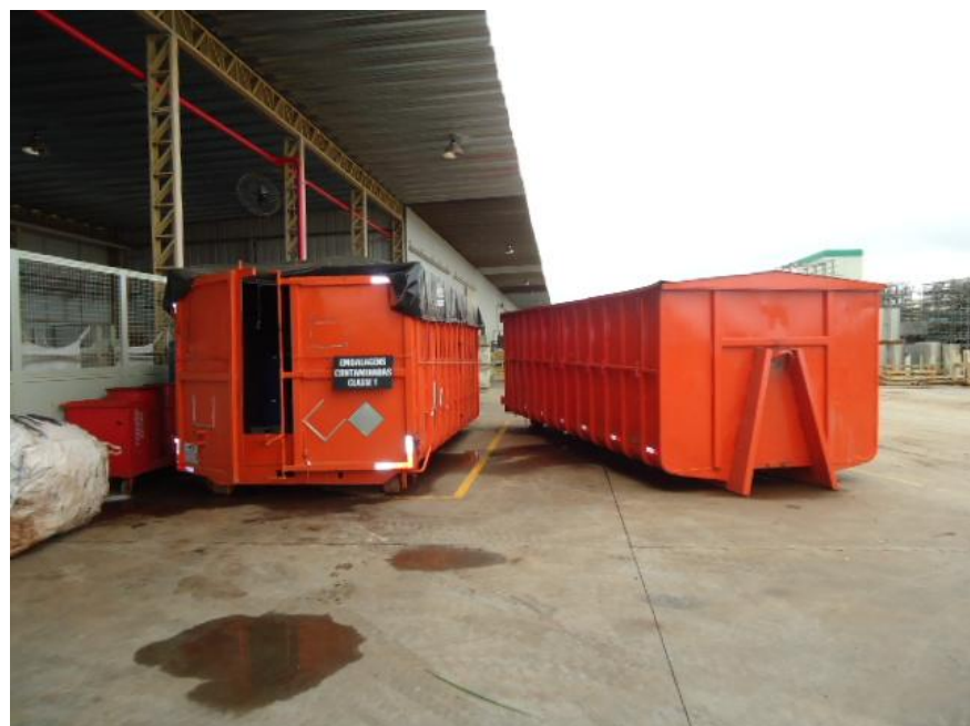
Figura 12: Caçamba para armazenamento de embalagens vazias contaminadas. Fonte: Indústria "D" (2011)
