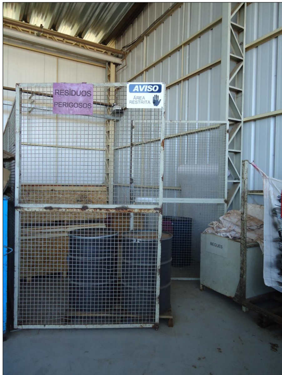
Figura 8: Tonéis de armazenamento de resíduos sólidos perigosos Fonte: Indústria "D" (2011)
