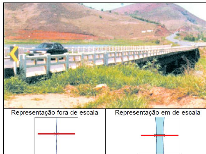
Figura 4 - Comparação entre a representação de uma rodovia em escala e fora de escala. Fonte: Convenções Cartográficas: Norma para emprego dos símbolos, 2002.
