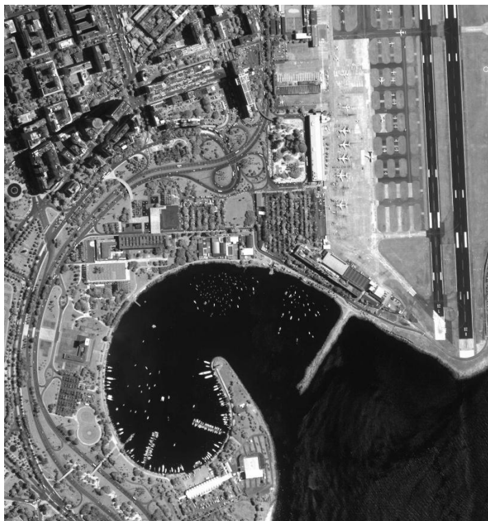
Figura 09: Cidade do Rio de Janeiro / Aeroporto Santos Dumont. Extrato de Cena IKONOS modo PAN, com 1 m de resolução, adquirida em 28-02-2000 com visada de 76.90 graus. 380Kb Copyright © 2000 SPACE IMAGING. Fonte: www.engesat.com.br , acessado em 17/02/2009.
