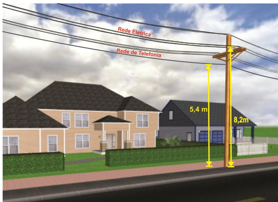
Figura 2.7 - Esquema da distribuição de fiação aérea.
