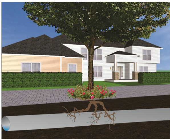
Figura 2.8 - Plantio inadequado de árvores cujas raízes estão interferindo nas canalizações subterrâneas.
