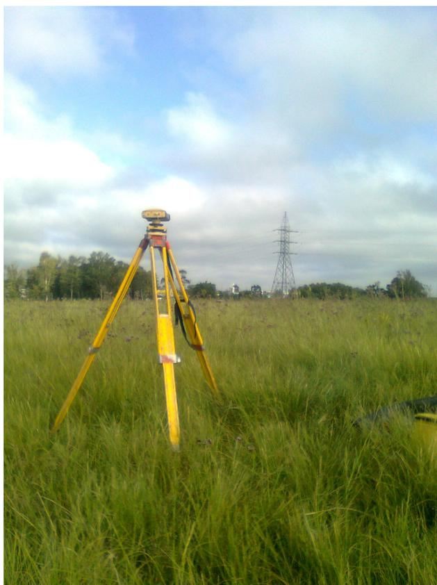
Figura 15 – Vista do receptor Topcon modelo Hiper em operação sobre um marco de apoio.
