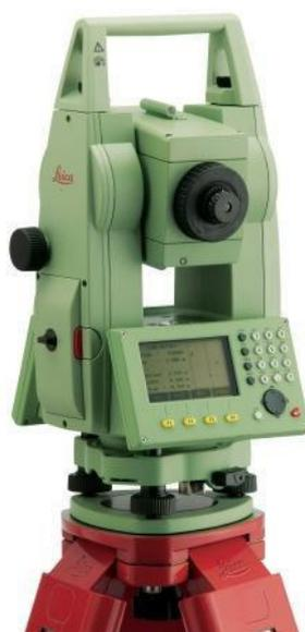
Figura 16 - Estação total Leica modelo TPS 805
