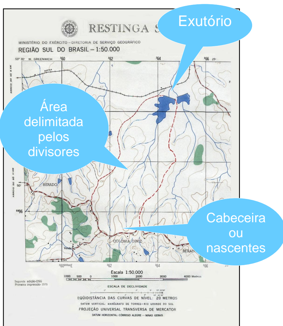
Figura 2.1 - Exemplo de bacia hidrográfica delimitada na carta topográfica.
