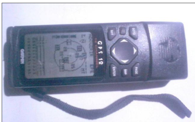
Figura 3.3 - Receptor Garmin modelo 12XL, para georreferenciar e marcar os pontos amostrais.
