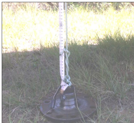
Figura 3.5 - Trena de 10 m ( fiber glass ) com lastro pesando 3kg, utilizada no levantamento para obtenção dos valores de profundidade estimada (trena).
