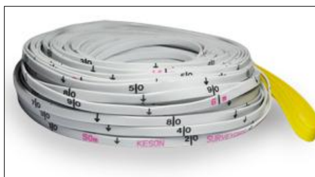
Figura 3.4 - Trena de ( fiber glass ).10 m, utilizada no levantamento para obtenção dos valores de profundidade estimada (trena).
